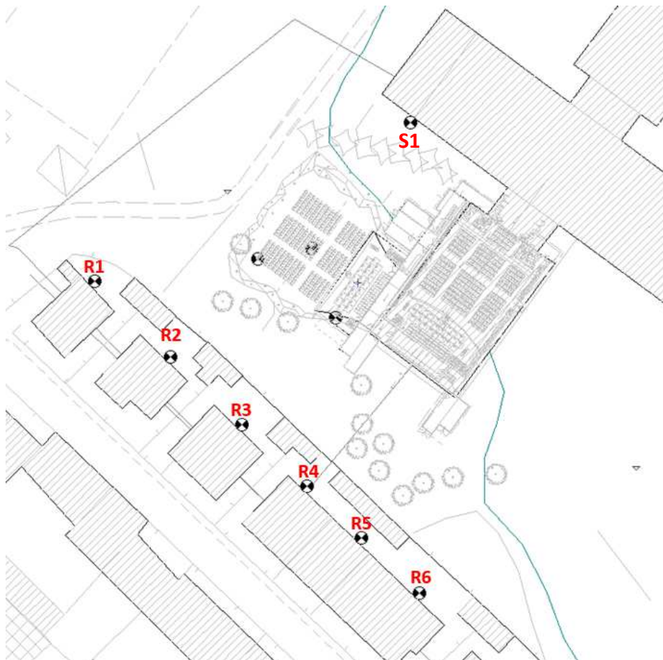
Figura 57 – Configurazione dell'acustica naturale: codifica dei punti ricettori
