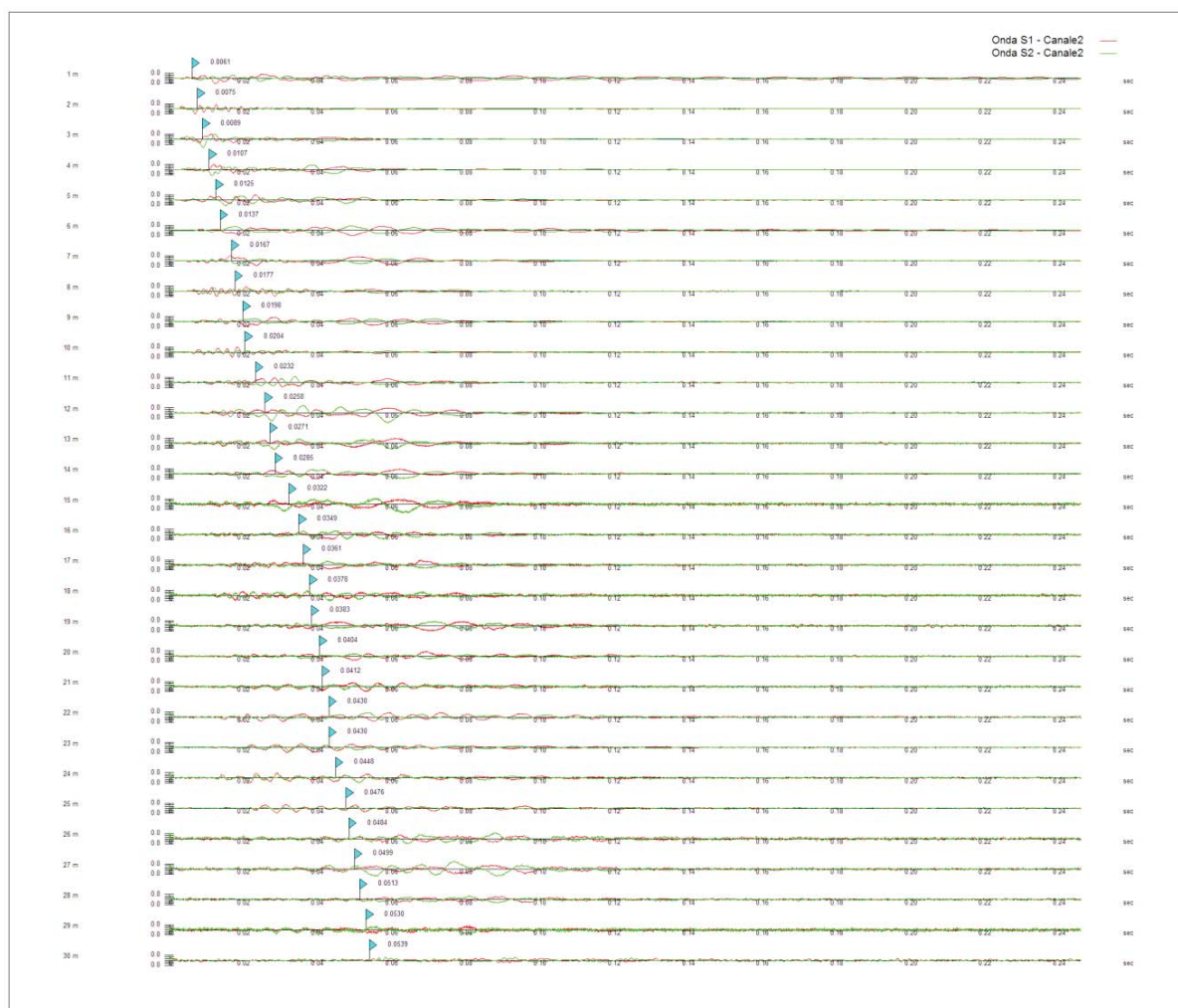
Figura 3-5: Elaborazione dati Down-hole con metodo diretto – Grafico comparativo primi arrivi Vs
