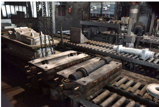
Foto 7 e 8 Lavorazione in laboratorio per creazione del calco e successivo getto di ghisa per un nuovo colonnino
