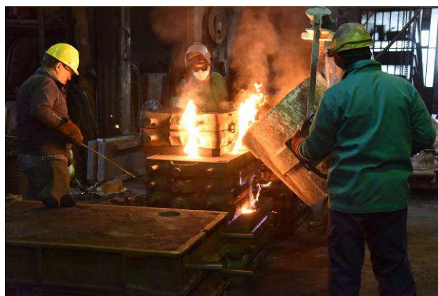
Foto 7 e 8 Lavorazione in laboratorio per creazione del calco e successivo getto di ghisa per un nuovo colonnino
