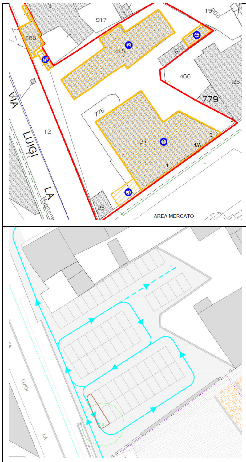
Figura 12 – Planimetria demolizioni e parcheggio in progetto
