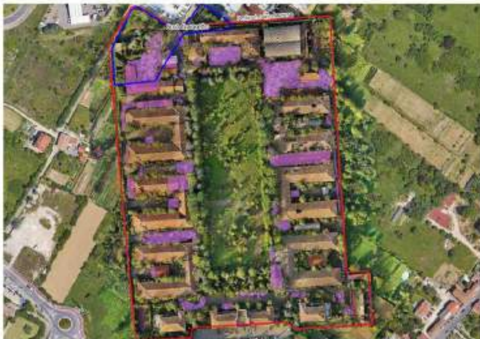
Figura 3. Ortomosaico effettuato a mezzo SAPR con indicato il collocamento dei rifiuti, il perimetro dell'ex compendio militare e l'area di progetto.
