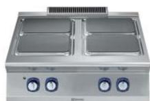
Puo' essere installata su basi neutre e refrigerate, supporti a ponte o a sbalzo. N. 4 piastre elettriche da 4 kw cad. in ghisa sigillate ermeticamente al top in un unico pezzo. Pannelli esterni in acciaio inox con finitura Scotch Brite. Piano di lavoro in acciaio inox stampato in un unico pezzo (spessore 2 mm). Bordi laterali a taglio laser ad angolo retto per una perfetta giunzione con altre unità.
