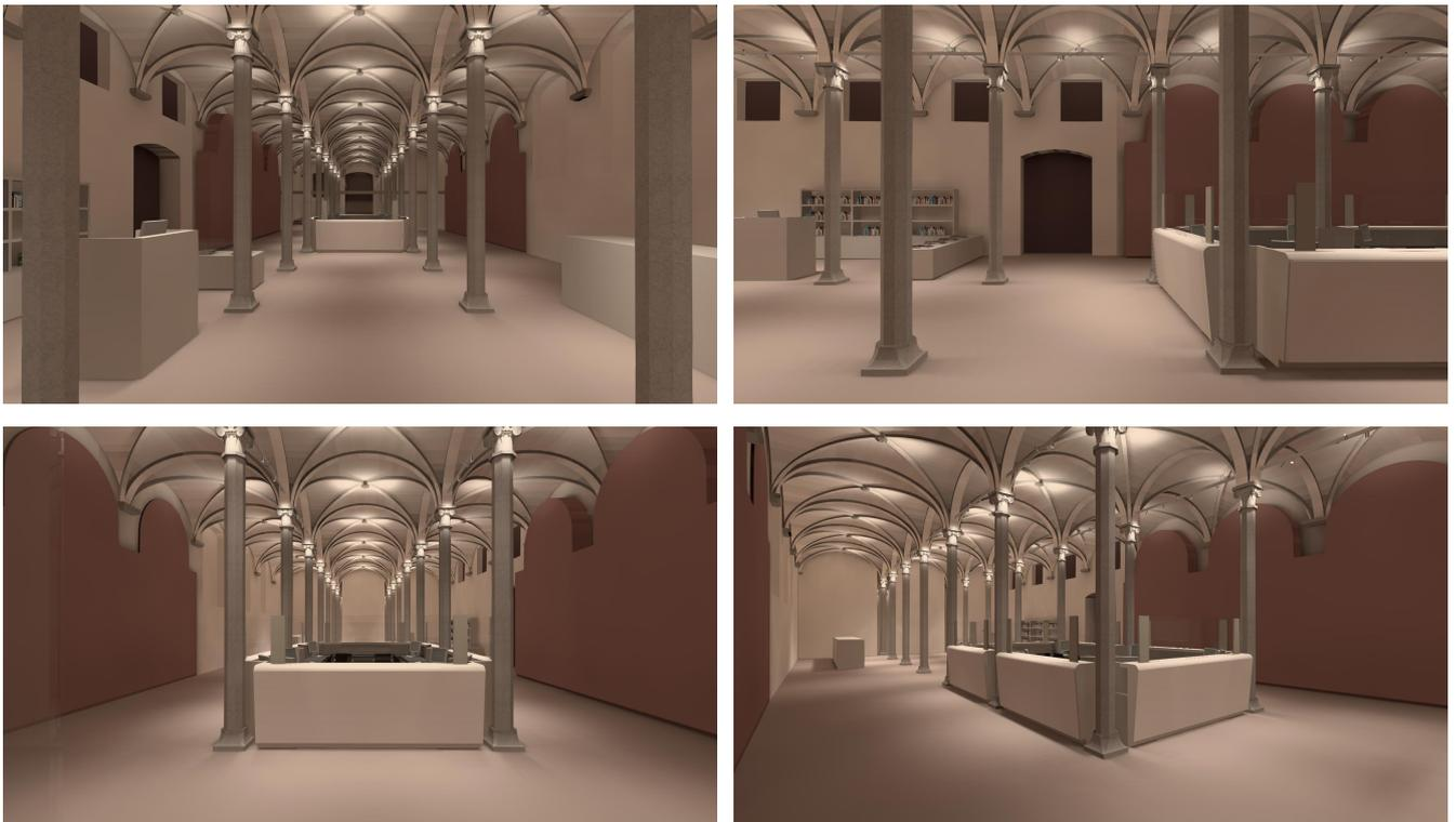
La collocazione delle postazioni video (4 videowall costituiti da 4 monitor da 55") e dei touch da 43" sarà sulle contropareti evidenziate in colore più scuro specularmente ai lati del desk dell'info point. L'installazione è a carico del fornitore degli apparati multimediali.
